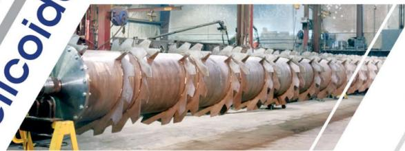
Helicoidales dúplex en acero inoxidable especial 2205, de 10.97 m de largo, 38" de diámetro, para manejar pulpa de papel.
