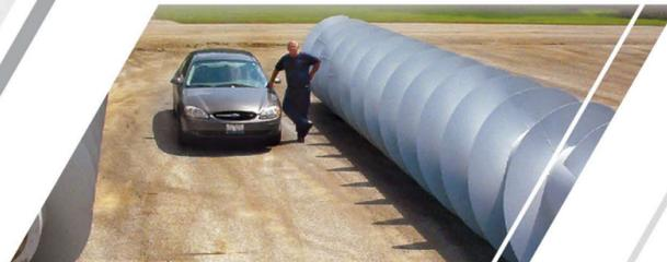
Helicoidales de doble paso para bombear agua, de 14.02 m de largo, 78" de diámetro, hechos por *Martin*.
